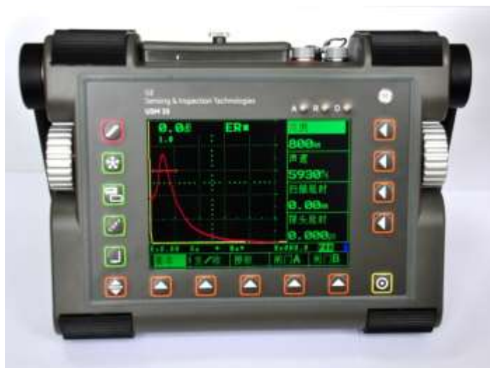
美国GE超声波探伤仪 American GE ultrasonic flaw detector
